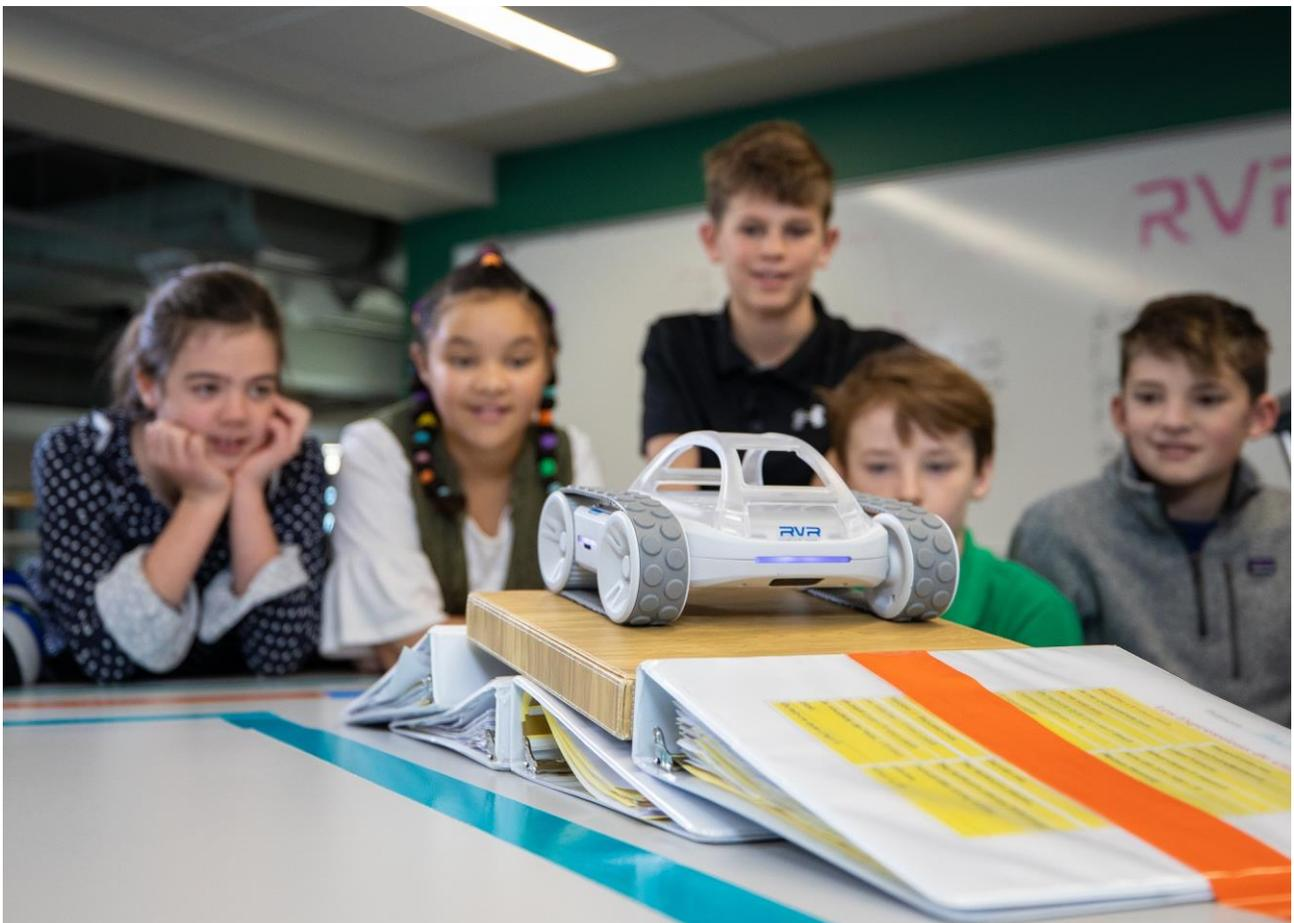
「Sphero RVR」は、さまざまなセンサーを搭載することで、子供自身の自由な発想で動作をカスタマイズできるプログラミングロボットです。6種類のセンサー（光センサー・赤外線センサー・ジャイロスコープ・カラーセンサー・磁力計・加速度計）を本体に搭載。また、RVRの前後左右に装備されている、計4個の赤外線センサーにより、ロボットと通信可能。Sphero以外の赤外線センサーを備えるさまざまなロボットとの通信を実現し、プログラミングの可能性を広げます。
